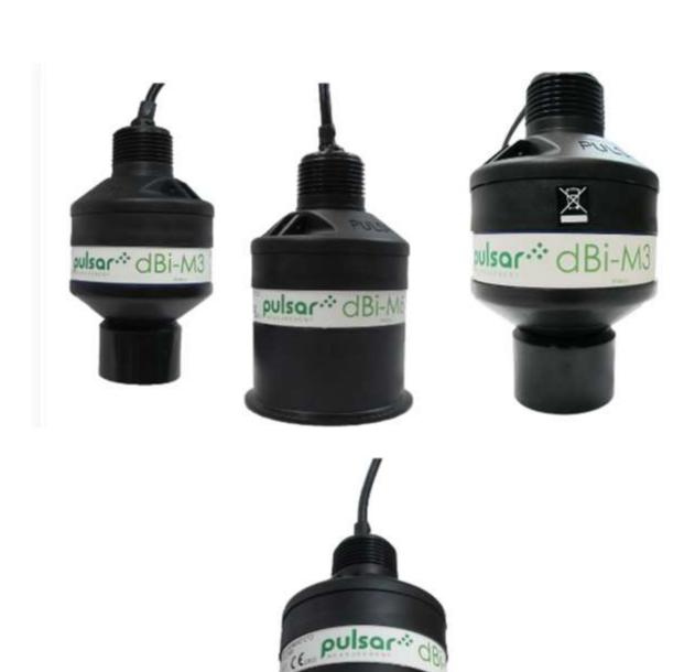
Серия преобразователей dBi Modbus (dBi-M) - это новейшие маломощные ультразвуковые датчики уровня, которые извлекают выгоду из связи по протоколу Modbus. Эта серия отличается ведущей в мире мощностью обработки эхо-сигналов DATEM для точных и надежных измерений в самых сложных приложениях с подходящим диапазоном измерения от 125 мм до 15 м (от 4,9 дюйма до 49,2 фута).
